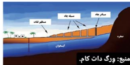
طرح کلی برای سیستم قنات
