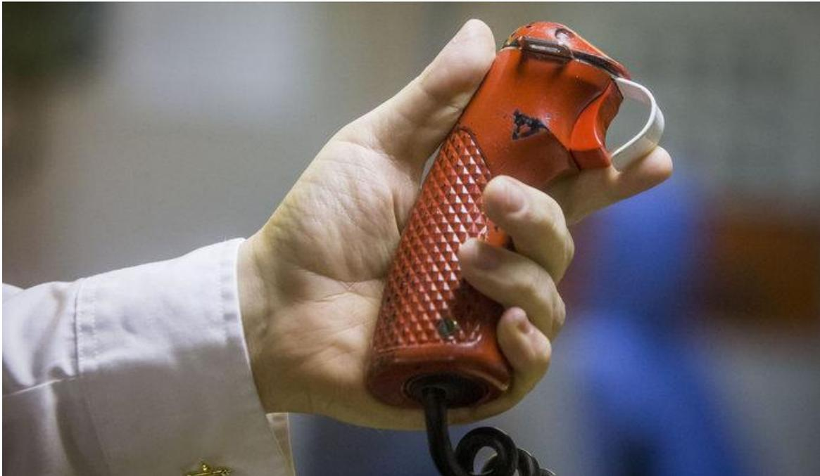
*Völkerrechtswidriges Massenvernichtungsmittel: Auslöse-Einrichtung zum Abfeuern von Atomwaffen auf dem britischen U-Boot »HMS Vigilant«*
